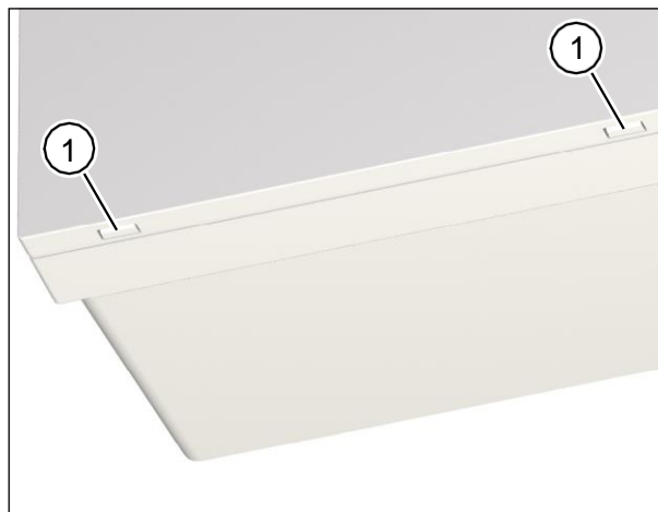
Рис. 34: Демонтаж захисного кожуху вентиляційної установки
