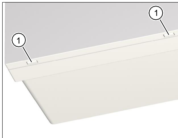
Рис. 25: Демонтаж захисного кожуху вентиляційної установки
