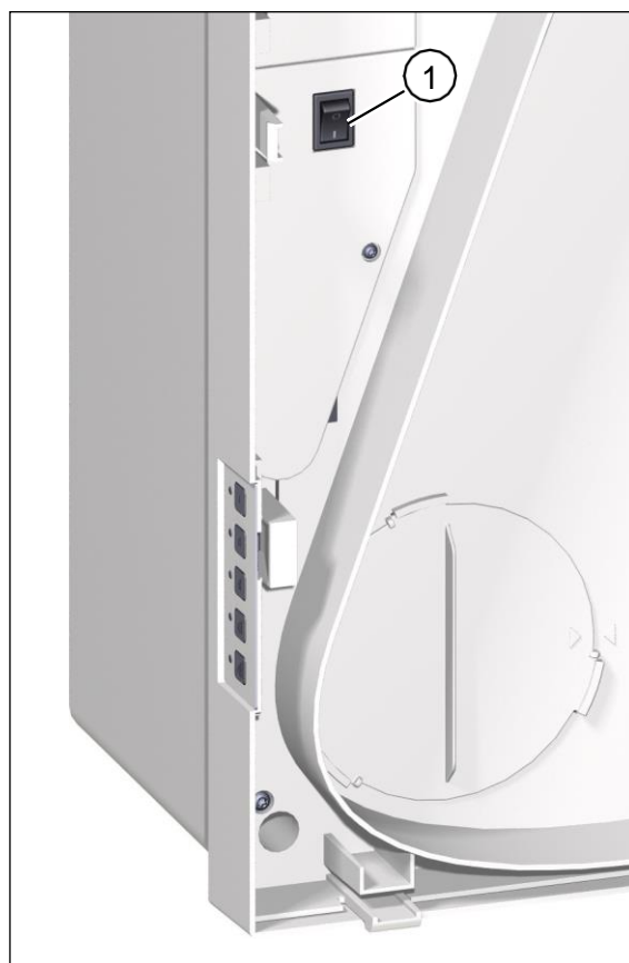
Рис. 14: Головна вимикач, його видно при зняттю захисному кожусі установки
