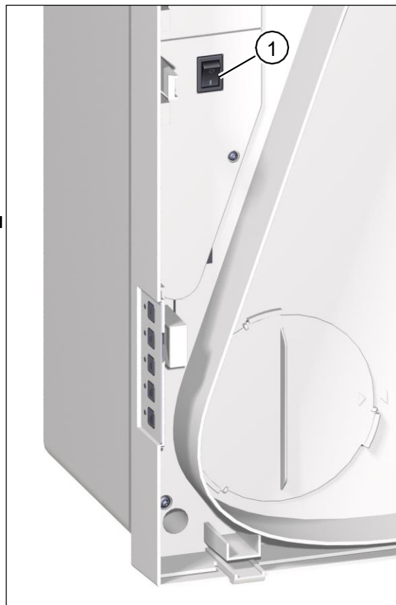
Рис. 17: Головна вимикач, його видно при зняттю захисному кожусі установки
