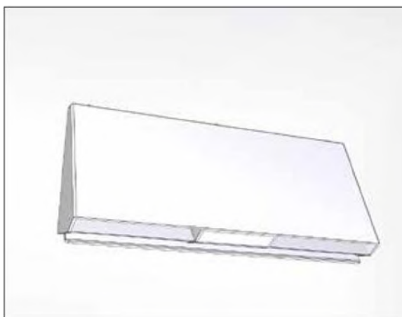
Рис. 42: прикрепите крышку воздухозаборника на фасаде здания
